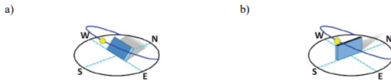
Obrázek 7- a) Horizontálně orientovaný BiEW modul; b) Vertikálně orientovaný BiSN modul [34]
